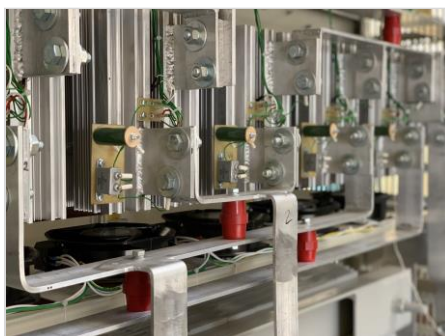
с принудительным воздушным охлаждением тиристоров от 1000А до 6300А
